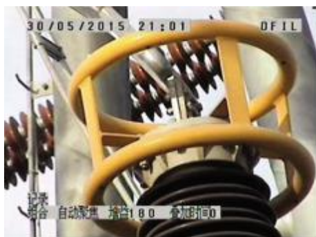
图 8 紫外放电检测照片
